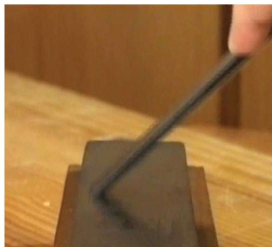
Durante o assentamento do fio a pedra tem que permanecer lubrificada, facilitando o deslizar da lâmina sobre a pedra, melhorando assim o poder do corte.
