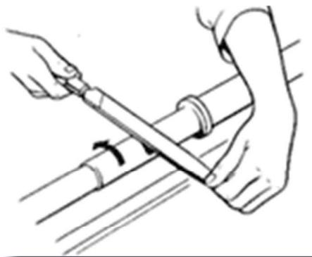
Ao limar peças em rotação num torno, a lima não deve ser mantida rigidamente ou permanecer estacionária, mas ser movimentada constantemente. Um rápido movimento de deslizamento ou em sentido lateral ajuda a lima a livrar-se das limaduras e evita a formação de saliências e sulcos. Embora seja possível usar uma
