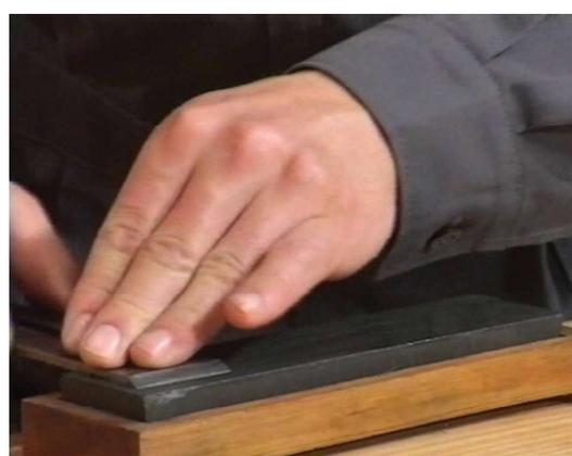
Seguidamente apoia-se completamente a face do ferro sobre a pedra, deslocando longitudinalmente (fig. 28).
