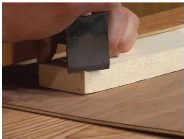
O assentamento do fio pode ser repetido sempre que necessário enquanto for visível a cavidade produzida pelo rebolo (fig. 32). Quando esta desaparecer, torna-se necessário voltar a retificar o chanfro (fig. 33) .
