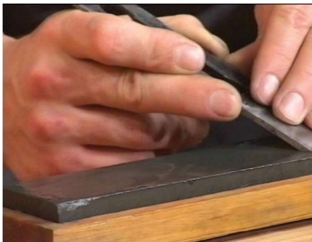
Estes movimentos repetem-se alternadamente até se eliminar completamente a rebarba inicial e o fio se encontrar alinhado com a face da lâmina.
