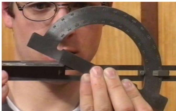
A superfície do chanfro resultante da afiação da ferramenta no rebolo deve ser plana ou ligeiramente côncava. Em nenhum dos casos, este chanfro deve ser abaulado ou ter um contra-chanfro. A aresta do gume deve estar sempre rigorosamente em esquadria com os (ângulos) lados da lâmina. Só as lâminas da plaina deve ser ligeiramente arredondadas nas extremidades do gume, para, durante o uso, não marcarem a madeira e dificultarem o aparelhamento.
