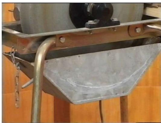
Fig. 12: Depósito de refrigeração
