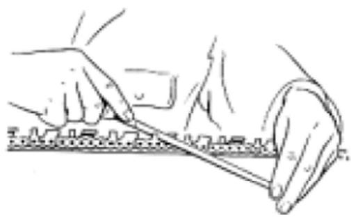
A lima é colocada contra a superfície chanfrada de corte dos dentes que se estendem para ambos os lados e asseguram a sua própria folga a um ângulo de 20° a 45° em relação à lâmina da serra, dependendo das especificações do fabricante.
